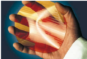
Guides d'onde à base d'Ormocers® hybrides déposés sur substrat flexible Photo : Fraunhofer ISC
